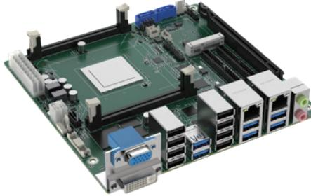
CITX-FT-D2000 是一款 Mini-ITX 主板，基于飞腾 D2000 处理器平台设计，2 根 DDR4 SODIMM 内存插槽，具备丰富外部接口。支持麒麟和统信国产操作系统
