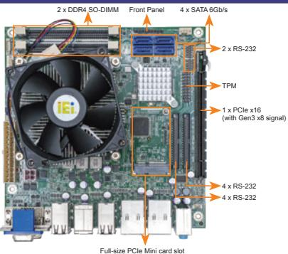
CITX-KX 是一款 Mini-ITX 主板，基于兆芯 KX-U6580/U6780A 处理器平台设计，2根 DDR4 SODIMM 内存插槽，具备丰富外部接口。支持麒麟和统信国产操作系统。
